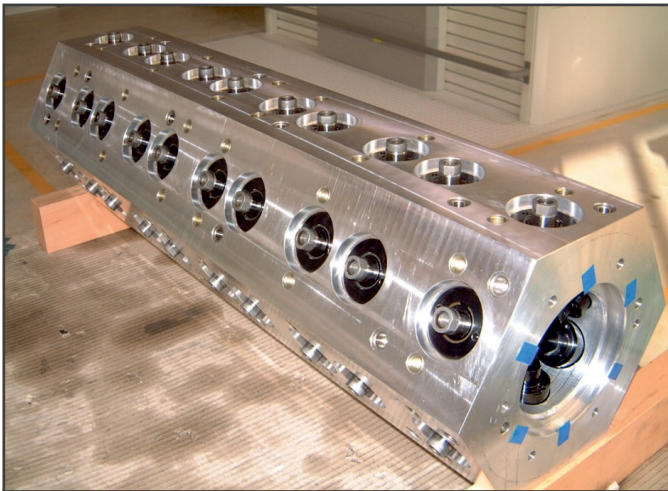
Einschraubzylinder im Vorrichtungsgrundkörper
