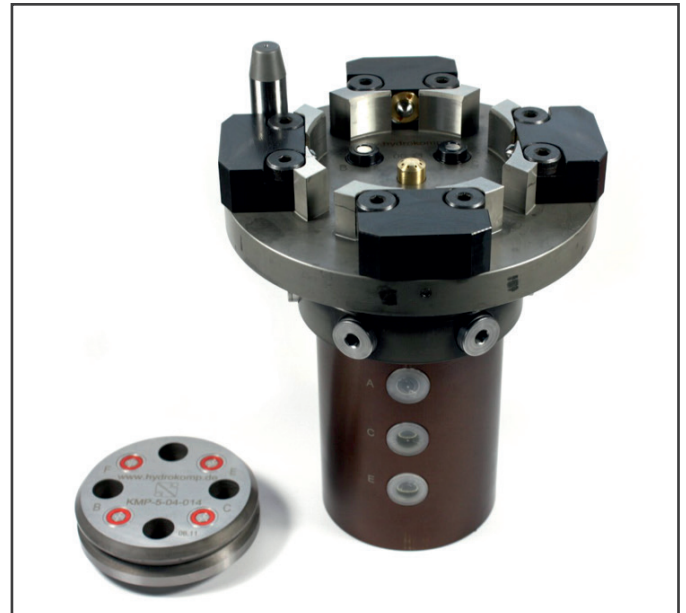
4-fach-Kupplungssystem mit hydraulischer Klemmung, Kupplungsnippel-Platte mit Blasdüse, kombiniert mit 6-adriger Drehdurchführung NW5, drucklos kuppelbar, (links) Kupplungsmechanikplatte
