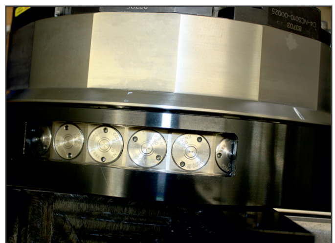
Kupplungsnippel im Revolver mit 36 Kupplungsnippeln
