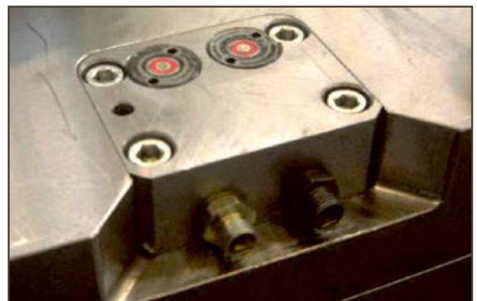
Vordere Werkzeugplatte, rotationssymmetrische Anordnung der Kupplungsrippel für 0^\circ - 180^\circ Stellung
