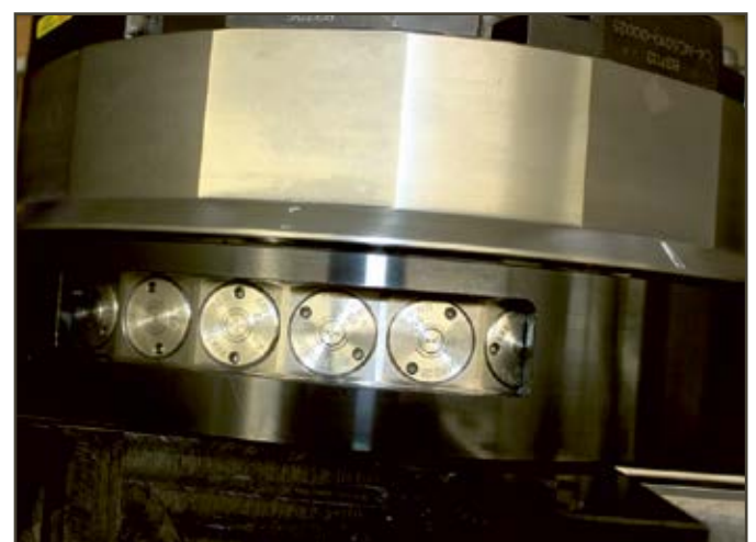
Kupplungsnippel im Revolver mit 36 Kupplungsnippeln
