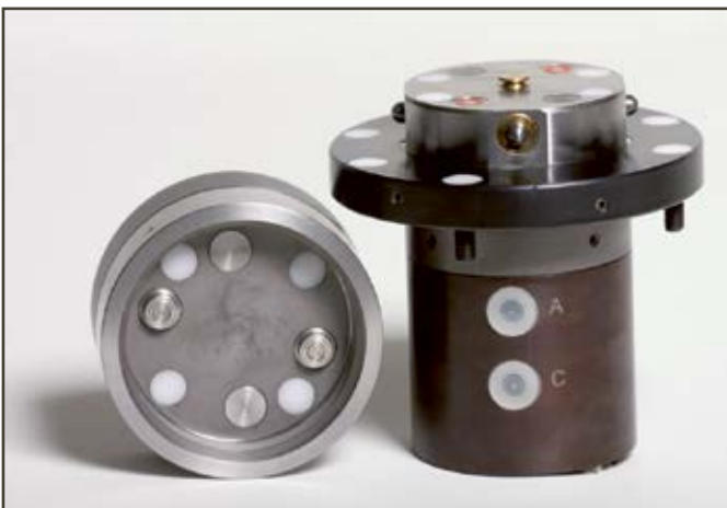
2-fach-Kupplungssystem mit hydraulischer Klemmung, Blasdüse und 4-adriger Drehdurchführung, drucklos kuppelbar.
