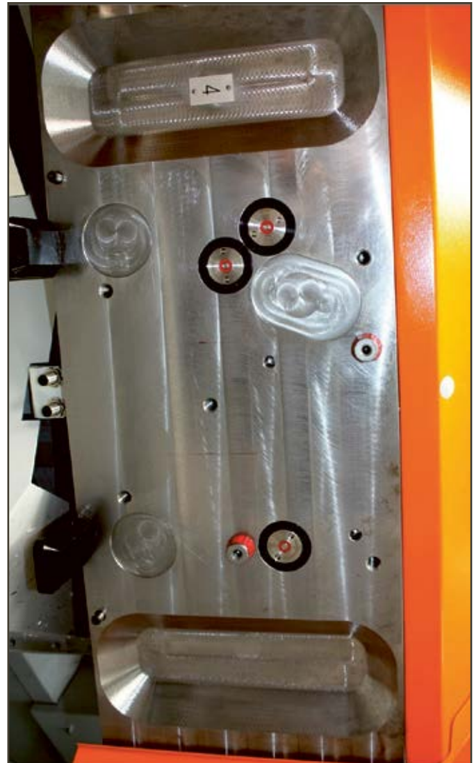
Der Grundkörper der Wechselvorrichtung enthält Kupplungen zum selbsttätigen Öffnen und Schließen der Hydraulikversorgung während der Be- und Entladevorgänge.
