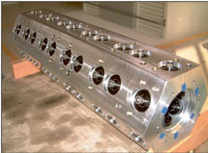
Einschraubzylinder im Vorrichtungsgrundkörper
